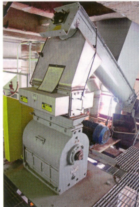
Der Messerwellenquerschneider von Munson zerkleinert Zimt und andere zähe, harte und faserige Wurzeln, Nüsse und Rinden
