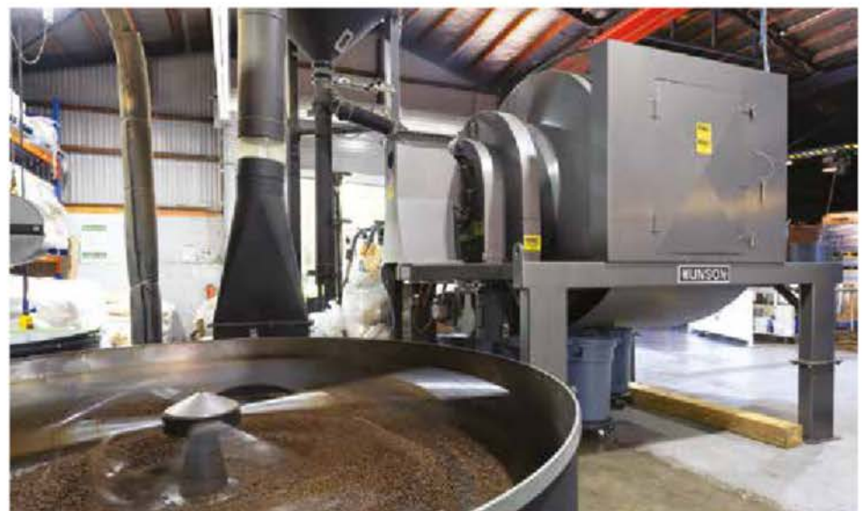
Les grains du torréfacteur reposent sur un bac de refroidissement avant d'entrer dans le mélangeur rotatif par charges d'une capacité de 2,1 m 3 .
