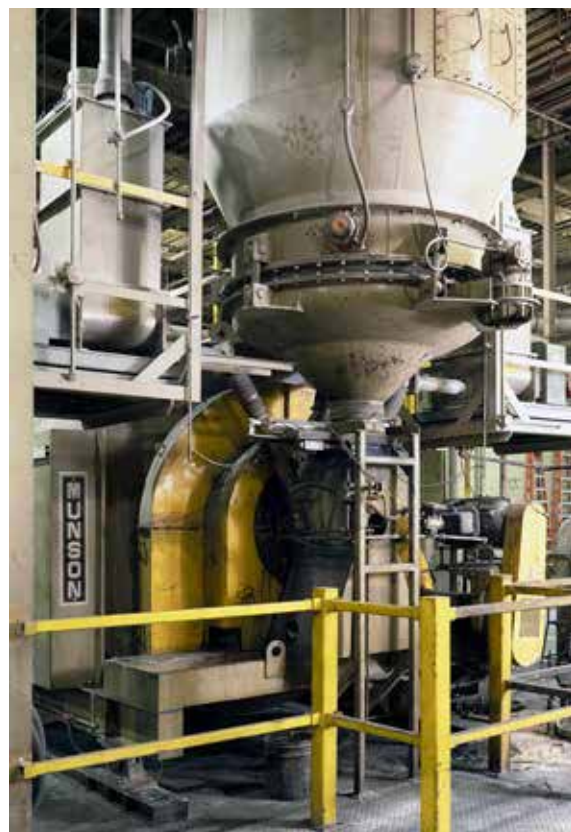
→ Pour remplir les récipients, un convoyeur pneumatique transporte les résines des unités de mélange vers une trémie de stockage.
