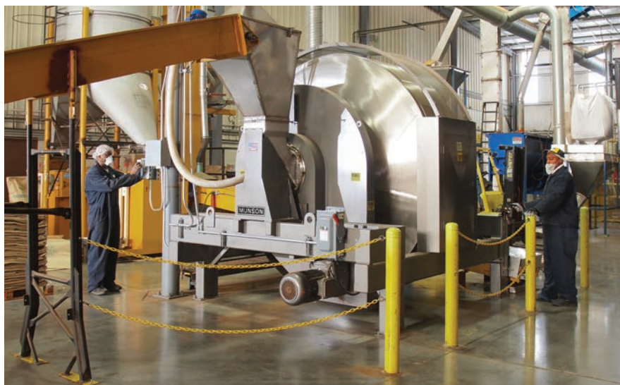
Tras pasar por una pantalla vibradora (izq.), se transporta el té a la Mezcladora Rotativa de Lotes de 3,9 m 3
